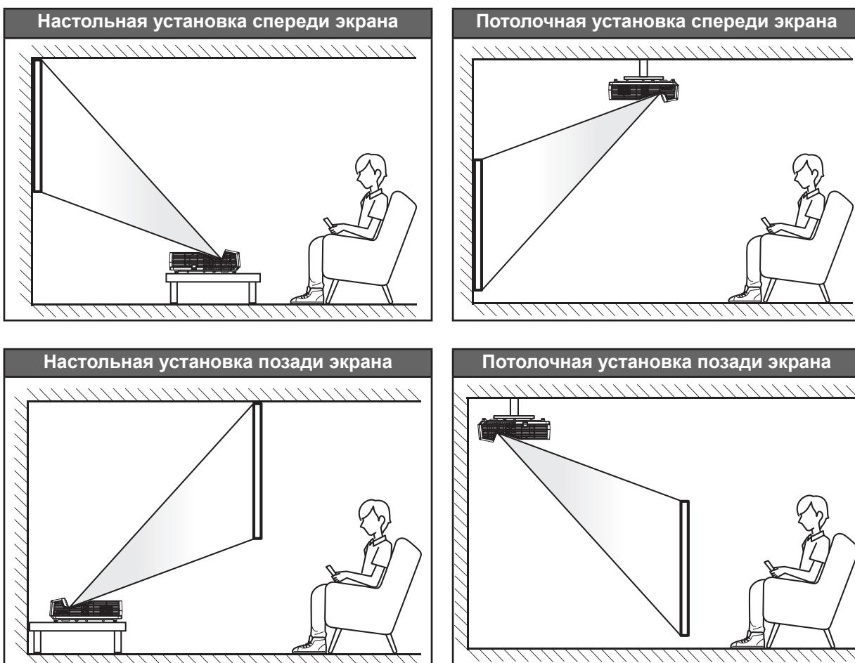
Проектор устанавливается на плоской поверхности и перпендикулярно экрану.
