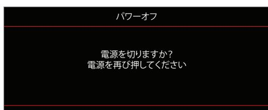
3. [P] ボタンを再び押して確認します。ボタンを押さない場合、10 秒後にメッセージが消えます。2 回目に [P] ボタンを押すと、プロジェクターはシャットダウンします。
