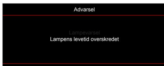
Når du ser denne meddelelse, skal du kontakte din lokale forhandler eller servicecenter og få udskiftet lampen hurtigst muligt. Sørg for, at projektoren har kølet ned i mindst 30 minutter, inden du udskifter lampen.
